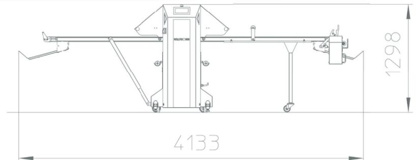
**ROLLFIX 600** – Das Premium-Modell für die Handwerksbäckerei. Der komplette Ausrollvorgang mit der Zustellung des Walzenspaltes verläuft vollständig automatisch und schafft so stets gleiche Ergebnisse. Die Bedienung über das neue Touch-Screen-Display ist einfach und komfortabel. Optional ist sie auch als 600W mit integriertem Langwirker erhältlich.
